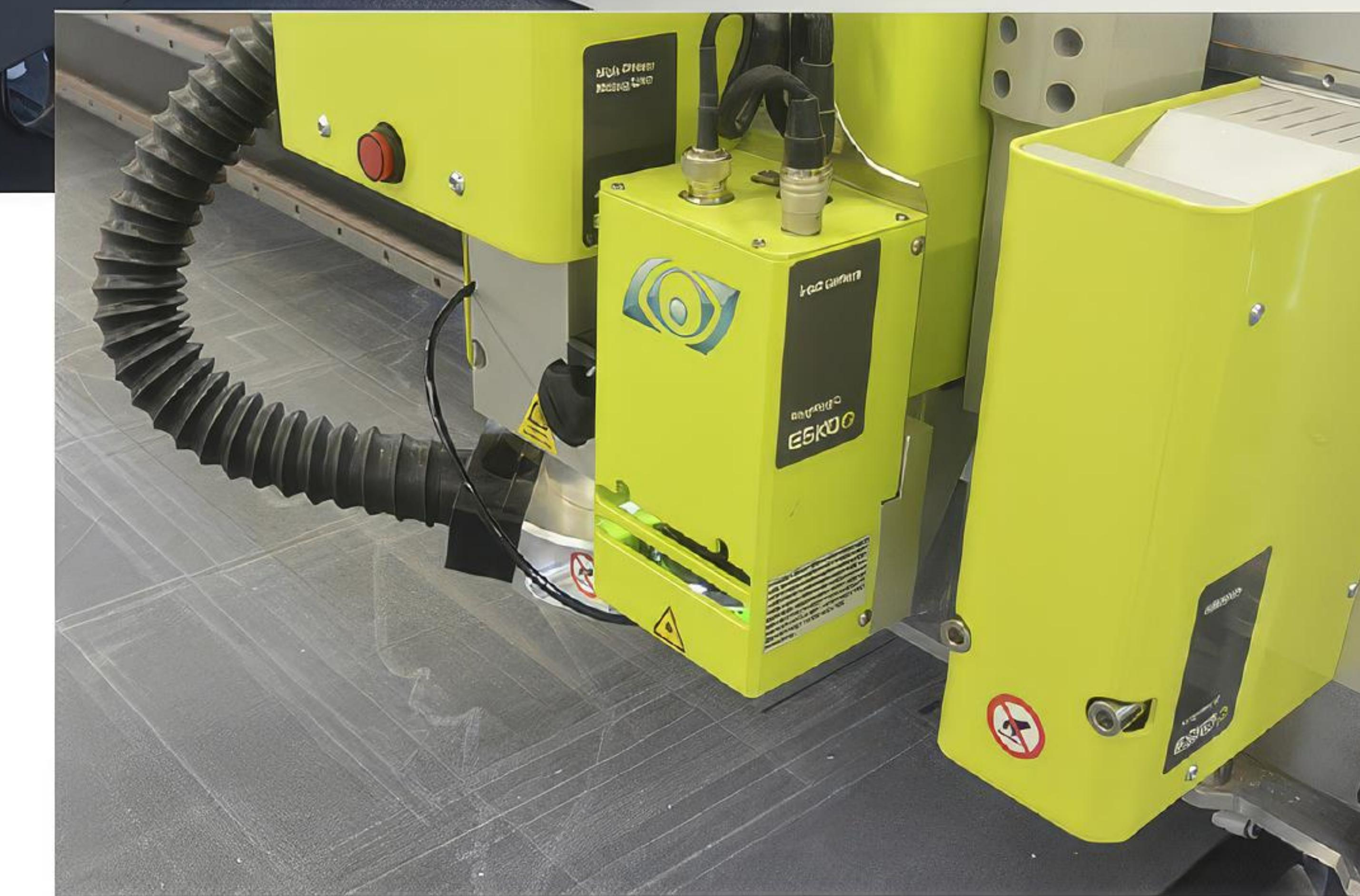
**Первая в России установлена в Невском Плакате.** Ширина рабочей зоны 3210\*3730 мм и конвейерная подача позволяет обрабатывать материалы размером до 3210 мм и любой длины.
